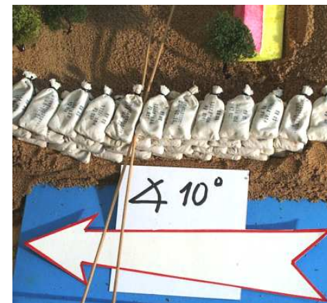
Obr. 13 Jednořadé kladení pytlů
