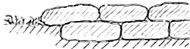
Obr. 15 Vázání hráze do terénu
