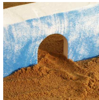
Obr. 25 Příložné těsnění s deskou
